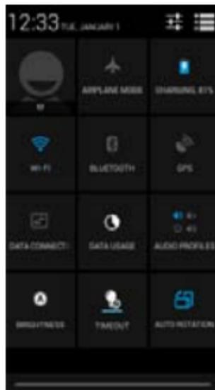
Auf dem Benachrichtigungsfeld sehen Sie die aktuelle Leistungsleisten Ihres Geräts und hier können Sie Sound, WiFi, Bluetooth, Flugmodus, Konten und Synchronisierung, Display auto. drehen, Helligkeit, Daten aktiviert, GPS prüfen und verwalten. Berühren Sie die Leistungsleistesymbole zum Ein-/Ausschalten und das Einstellungs-Symbol um die Leistungsleisten ausführlich zu verwalten.
