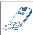
Para abrir, presione el clip de la batería y levántela
