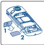
Coloque la tarjeta SIM con el chip hacia abajo
