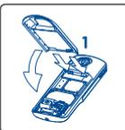
Inserte y empuje la batería hacia abajo
